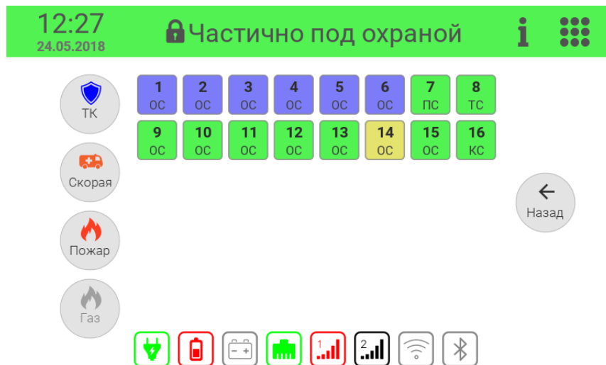
Рисунок 11 – Состояние источников питания, каналов связи и подключенных к КОП датчиков и зон
