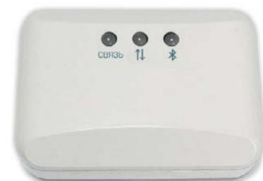
Модуль расширения для приборов серии Приток-А КОП. Подключение к прибору по шине RS-485, подключение по каналу Bluetooth беспроводных устройств на ОС Android (смартфон, коммуникатор, планшет и т.д.), интерфейс связи Bluetooth 2.0, питание от внешнего источника 11-16 В.
