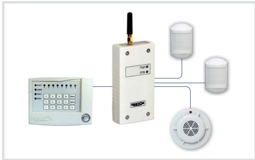
Принцип действия микрорадиоохраны Приток-МКР основан на создании радиосети с динамической маршрутизацией, в которой каждый узел связи является передатчиком, ретранслятором и прибором приемно-контрольным.
