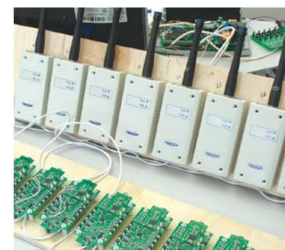
функционал с -05 исполнением, но, в отличие от Приток-А КОП-05 контроллер не имеет встроенного блока питания и аккумулятора, за счет чего он получился меньше и легче предыдущей модели.
