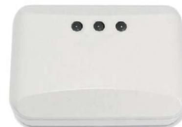
Модуль расширения беспроводных датчиков для приборов серии Приток-А КОП. Подключение к прибору по шине RS-485, подключение беспроводных датчиков Ладога-РК, питание от внешнего источника 11-16 В.
