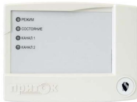
ПП-04 предназначен для подключения внешних приборов типа Сигнал-ВК-4, УО-1А, УО-3К, УО-Орион по каналам связи Ethernet/GPRS с пультом централизованной охраны объектов и квартир в составе «Автоматизированной системы охранно-пожарной сигнализации Приток-А».
