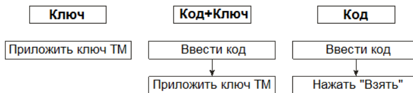
Рисунок 2 – Постановка под охрану без выбора шлейфов
